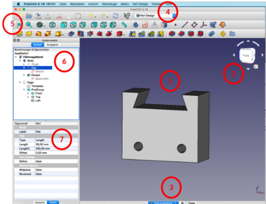
1. **Konstruktionsbildschirm:** Hier führst du alle Konstruktionsschritte durch
