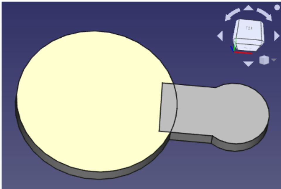
Damit der Einkaufschip als ein einziger Körper ohne Überlappung dargestellt wird, muss im Verzeichnisbaum „Pad Steg+Öse“ markiert und Refine auf true gesetzt werden.
