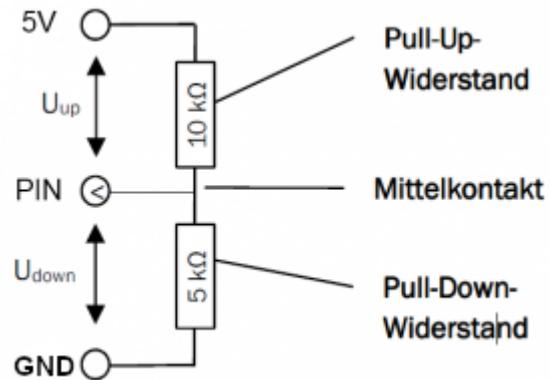
Diese Schaltung bezeichnet man als **Spannungsteiler mit einem Mittelkontakt**. Der **Pull-Up-Widerstand**  $R_{up}$  und der **Pull-Down-Widerstand**  $R_{down}$  teilen sich die Gesamtspannung entsprechend ihrer Anteile am Gesamtwiderstand in die Spannung  $U_{up}$  und  $U_{down}$  auf.
