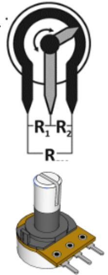
Dadurch besteht das Poti im Prinzip also aus zwei regelbaren Widerständen in einem Bauteil — also einem Spannungsteiler. Baue eine entsprechende Schaltung auf und lass dir die Werte ausgeben.
