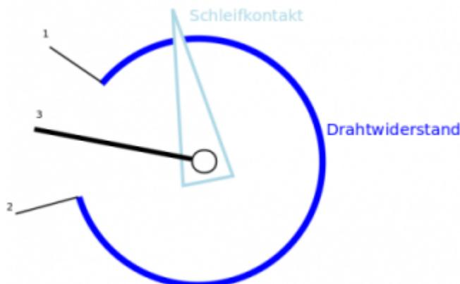
Das Schaltzeichen eines Potentiometers sieht entsprechend wie folgt aus, wobei der Schleifkontakt durch den Pfeil symbolisiert wird.
