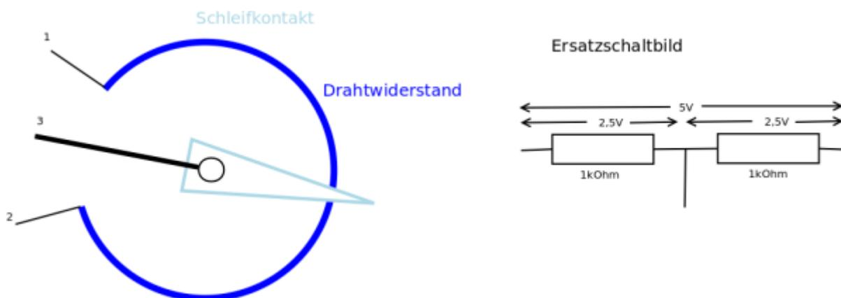
In diesem Fall halbiert der Schleifkontakt den Gesamtwiderstand und damit auch die Gesamtspannung. Man kann das Potentiometer im Ersatzschaltbild wie im Bild zu sehen durch zwei
