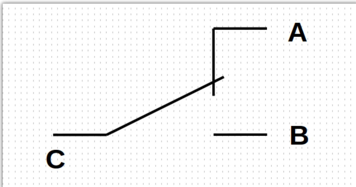
Ein Wechselschalter hat drei Anschlüsse und zwei Schalterstellungen:
