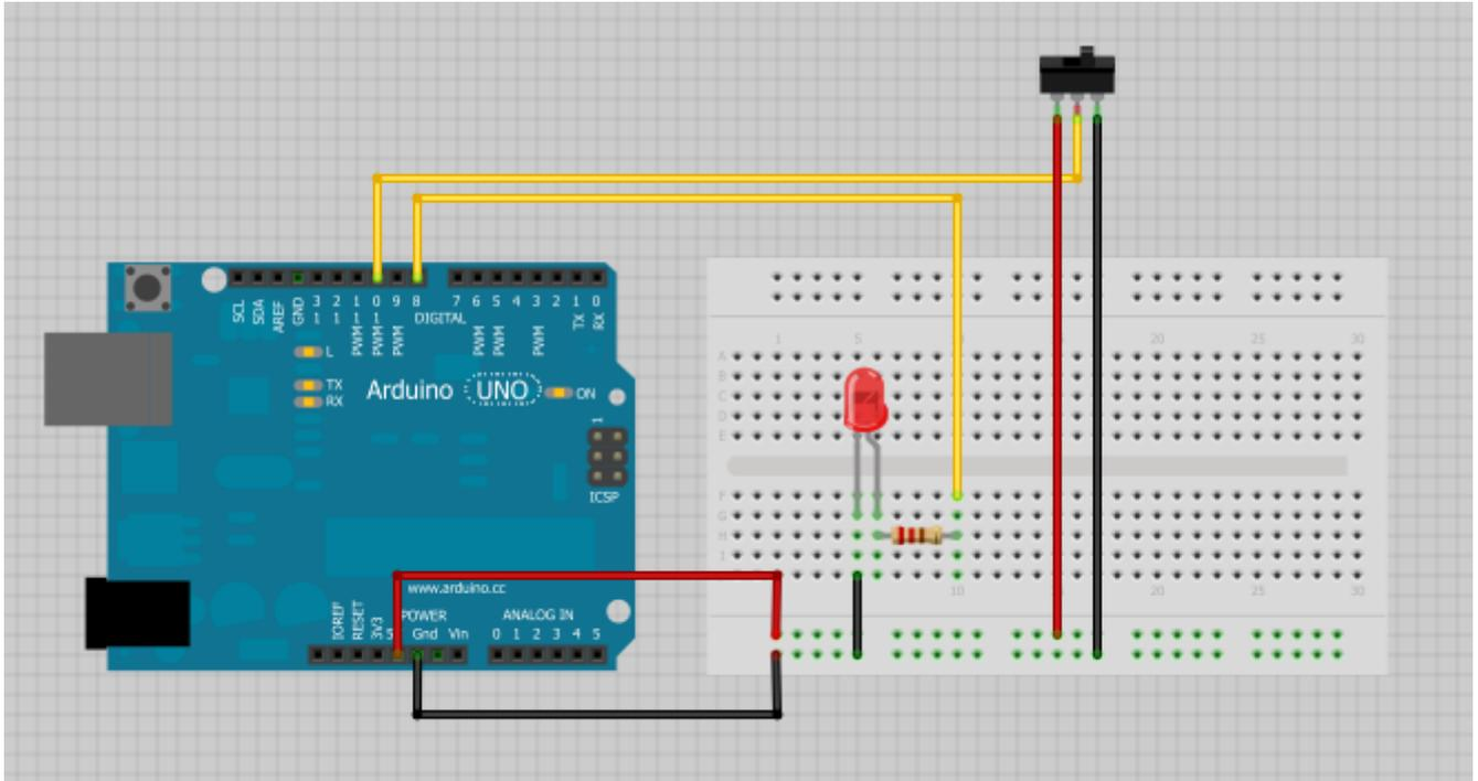
Beachte, dass aus dem Bildchen nicht hervorgeht, wie du deinen Wechselschalter genau anschließen musst. Achte darauf, dass bei keiner Schalterstellung Plus- und Minuspol miteinander verbunden sind, sonst gibt es einen Kurzschluß.
