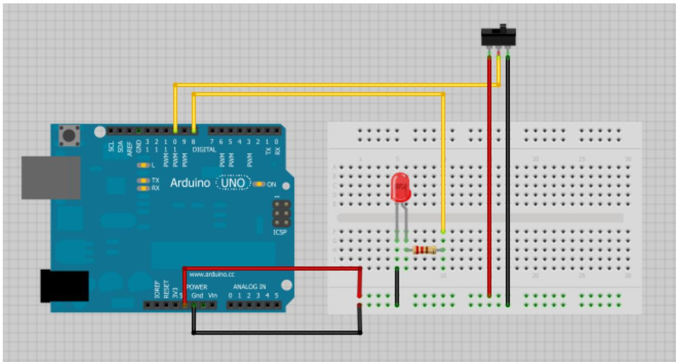
Beachte, dass aus dem Bildchen nicht hervorgeht, wie du deinen Wechselschalter genau anschließen musst. Achte darauf, dass bei keiner Schalterstellung Plus- und Minuspol miteinander verbunden sind, sonst gibt es einen Kurzschluß.
