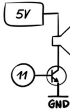
Dein Lautsprecher ist relativ leise, weil der Arduino durch seine Pins nur geringe elektrische Leistungen leiten kann. Höhere Leistung kannst du am Pin V\_in beziehen, das aber nicht programmierbar sondern einfach immer an ist. Mit einem Transistor kannst du trotzdem V\_in für den Lautsprecher nutzen.
