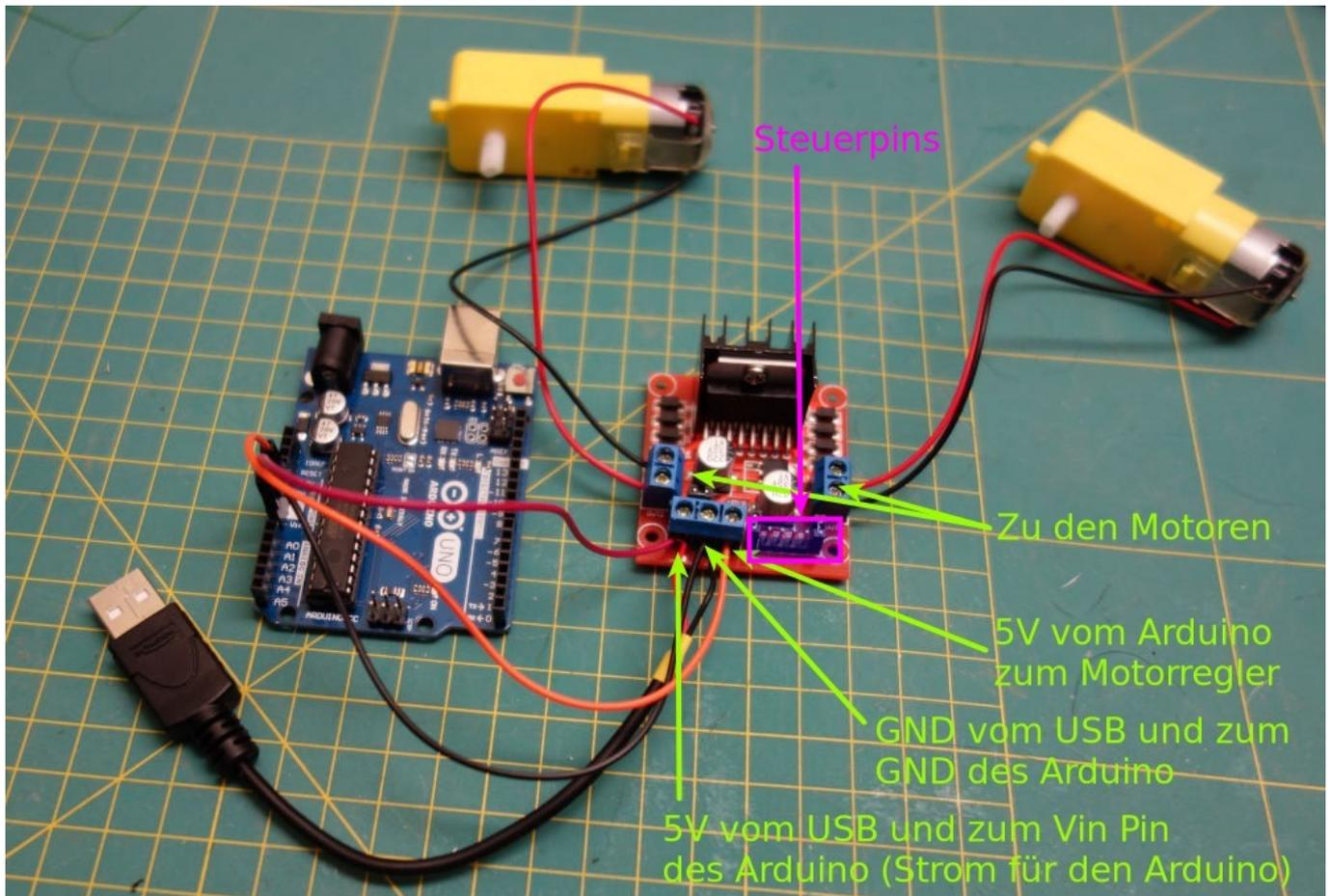
Über die rechten beiden Steuer-Pins wird den rechts angeschlossene Motor gesteuert. Ist das eine HIGH und das andere LOW, dreht er sich in eine Richtung - umgekehrt In die andere. Sind beide HIGH oder LOW, steht er still. Die linken beiden Pins sind für den linken Motoranschluss.
