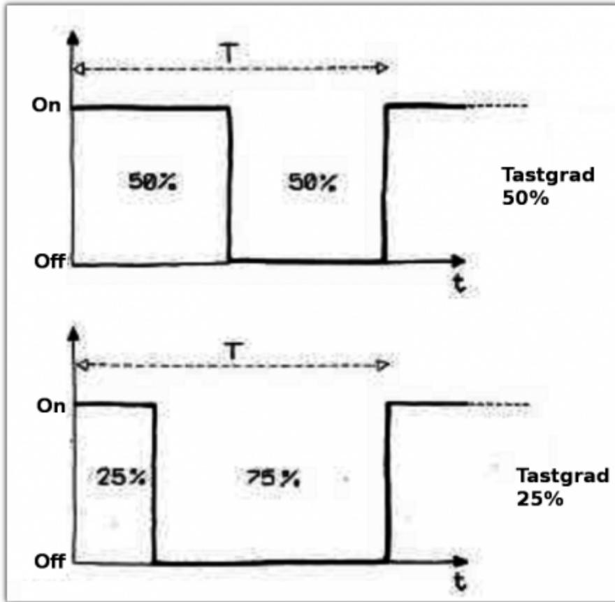
**Hinweis:** Die Anweisung `analogWrite()` funktioniert ideal mit den Pins 9 und 10, bei 3 und 11 beeinflusst sie die `tone()`-Anweisung, bei Pins 5 und 6 geht eine LED nie ganz aus. Wie auch `tone()` schaltet `analogWrite()` einen Pin automatisch auf OUTPUT.
