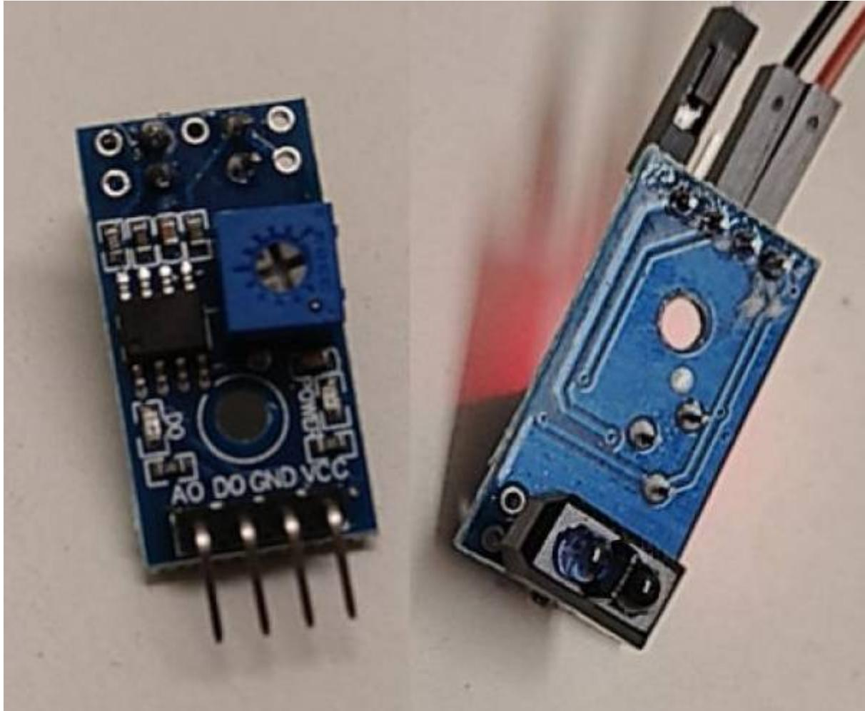
Am Sensor befindet sich eine Infrarotleuchtdiode, die für den Menschen unsichtbares Infrarotlicht vom Sensormodul abstrahlt. In gleicher „Blickrichtung“ befindet sich am Sensormodul ein Fotowiderstand. Wenn sich dem Sensor ein Gegenstand nähert, wird das Infrarotlicht am Gegenstand reflektiert und vom Fotowiderstand detektiert.
