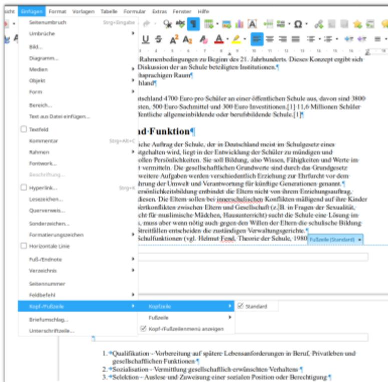
Kopf und Fußzeilen aktiviert man durch „Einfügen→Fußzeile“ und entsprechend für die Kopfzeile. Macht man das Häkchen bei Standard, erscheint die Fußzeile und man kann dort
